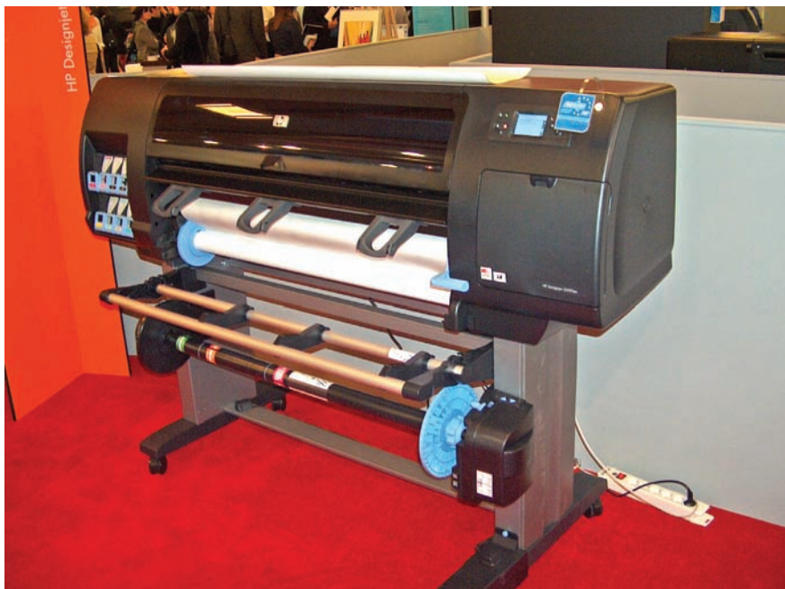
Одно из существенных отличий принтера HP Z6100 — высокая скорость печати, составляющая 105,4 м 2 /ч в режиме Production, позиционируемом для коммерческой печати оперативных заказов, не требующих безупречного качества, 66,9 м 2 /ч в режиме Fast mode и 9,1 м 2 /ч в режиме Best mode на глянцевой бумаге
