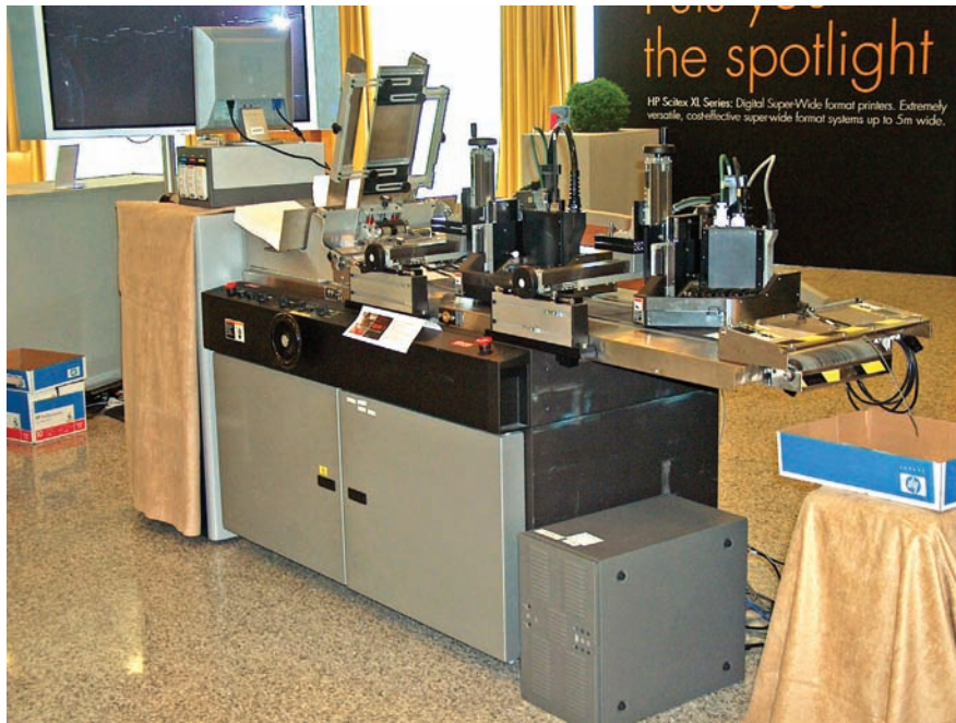
Демонстрационный образец системы струйной печати на базе модулей HP mPrinter 1700 смонтирован на промышленном конструктиве от Videojet
