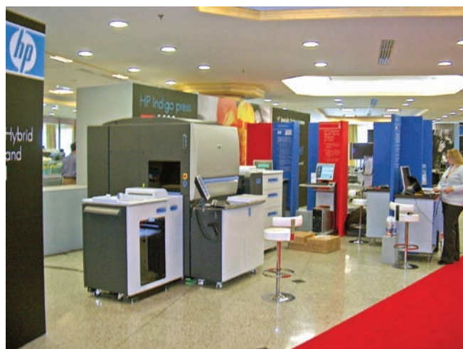
Производительность HP Indigo 5500 осталась на прежнем уровне — 4000 стр./ч в 4-цветном режиме, ежемесячный ресурс — 1,5 млн цв. или 5 млн ч/б страниц
