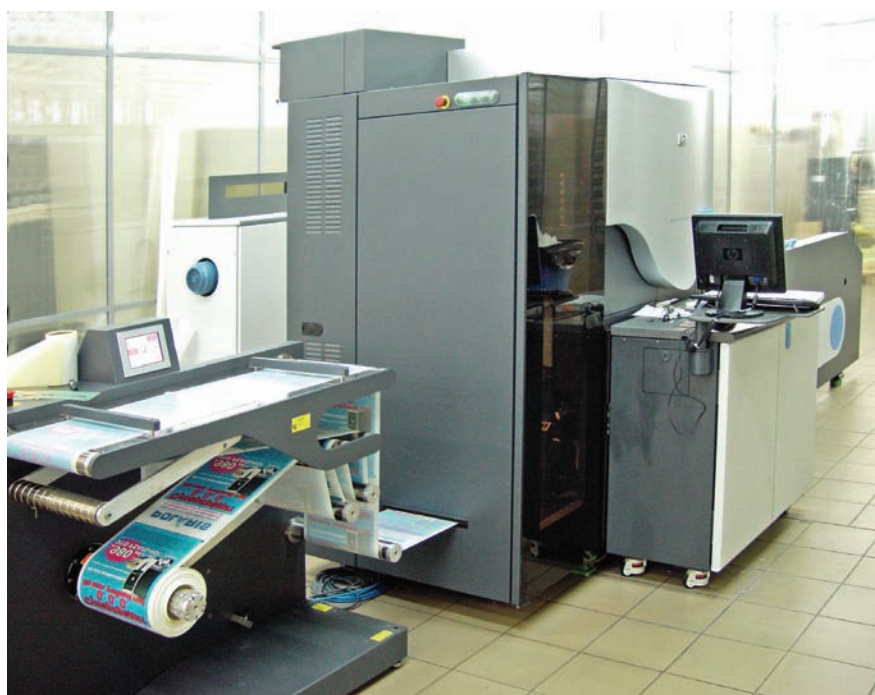
Одна из новых возможностей цифровой печатной машины HP Indigo ws4500 — плавная регулировка печатного натиска
