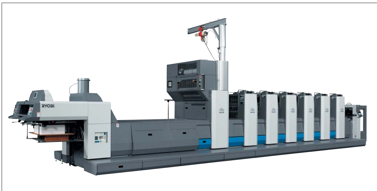
Рис. 1. Общий вид печатной машины Ryobi 750 с установленной опцией голографического лакирования и нанесения фольги в линию
