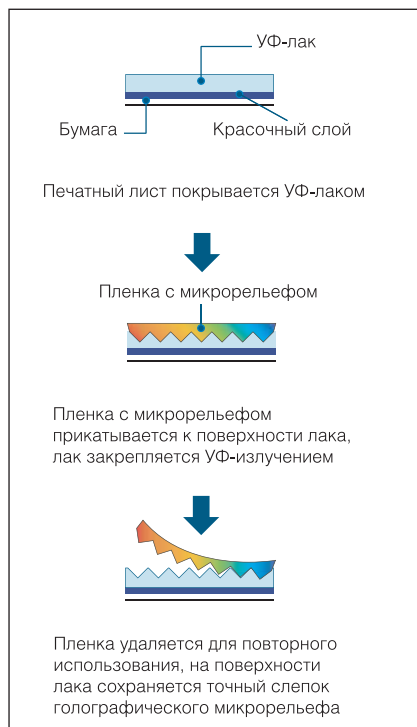
Рис. 3. Схема процесса голографического лакирования в линию
