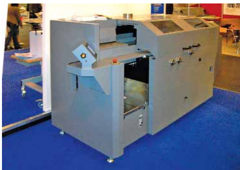
Автоматический аппарат для клеевого бесшвейного скрепления блоков DuBinder оснащён пневматической системой подачи обложек (от 120×240 до 360×695 мм)
