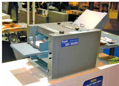
В памяти компактной фальцевальной машины DF-1000 с пневматической подачей листа хранится 5 стандартных типов фальцовки и один пользовательский (опционально)
