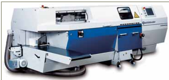
Рис. 1. Специальное устройство для бесшвейного скрепления Quickbinder от Wohlenberg
