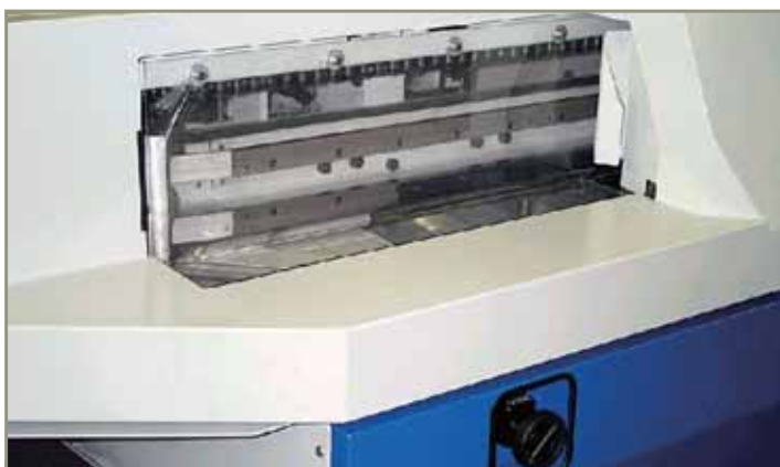
Рис. 2. Подобранный блок перед подачей в зажимную каретку сталкивается и выравнивается по корешку и боковому упору
