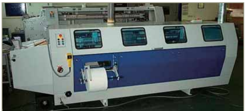
Рис. 8. Узел приклейки марли
