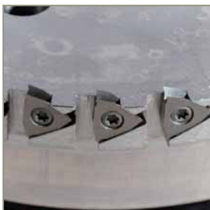
Рис. 4. После фрезерования корешок дополнительно обрабатывают торсионующей фрезой, которая имеет съемные зубья
